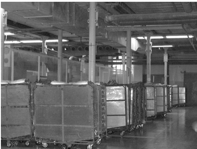
Vozički za prevoz navitkov v predpredilnici. Foto: Nina Vodopivec, 9. 9. 2005
